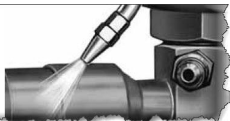
طریقه صحیح جوشکاری با شعله سرپیک در خلاف جهت بدنه
